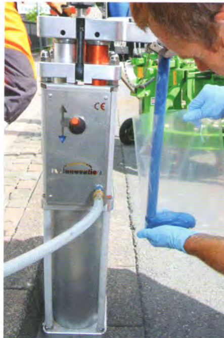
Mit der Pastenmischanlage mit Statikmischer wird das Harz luftfrei, sauber und sicher gemischt.
