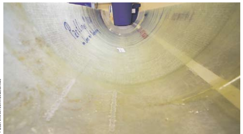
In einer Entfernung von einem Zentimeter hat die Spüldüse im Spülversuch - hier nachgestellt - in mehreren Zyklen jeweils mit einer Durchflussmenge von 35,7 l/min Wasser auf das Probestück gestrahlt. Eine Herausforderung, der der PARTLINER™ gänzlich unbeeindruckt getrotzt hat.
