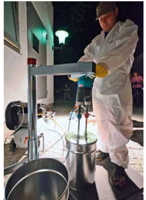
Komfortlösung: Das gleiche Gerät mit Ständer. Hier kann man ohne Ermüdung auch mal eine Minute länger und damit gründlicher rühren.
