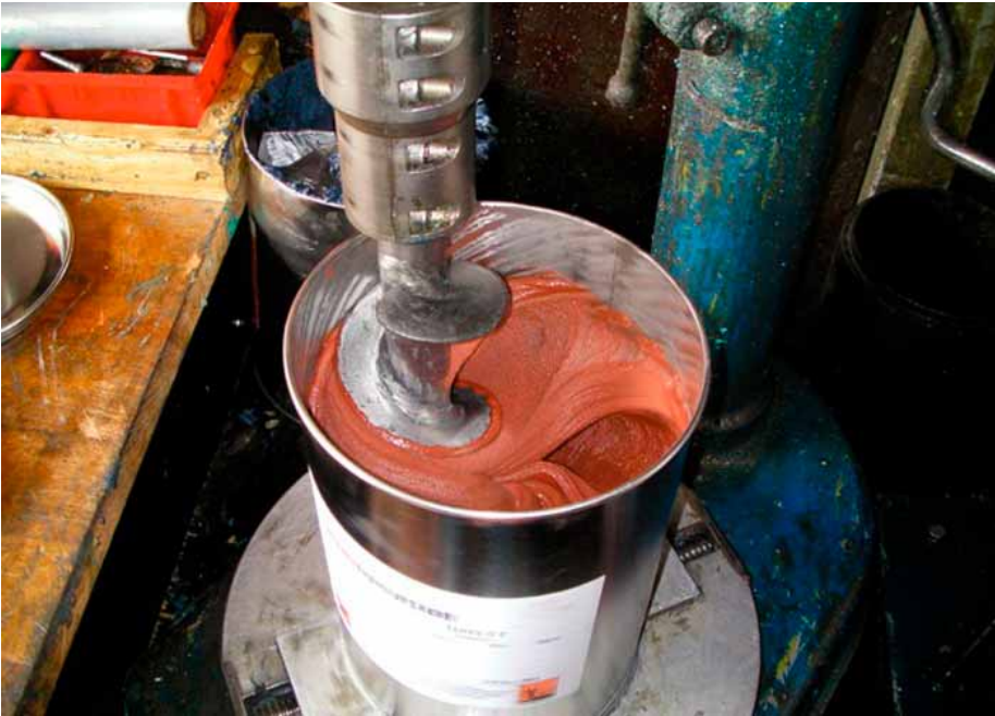
Schneckenrührer. Vorteil: Geringer Lufteintrag
