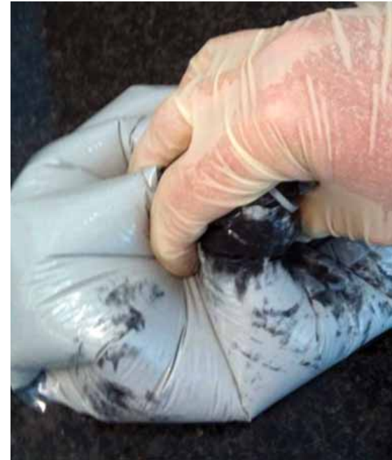
Harzmischen durch Kneten im Kunststoffbeutel. Kein Lufteintrag, dafür ein unberechenbarer Wirkungsgrad.
