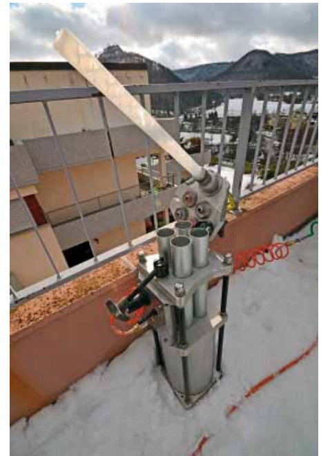
Statikmischer mit 4 Schächten für Schlauchbeutel.
