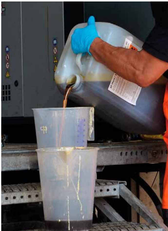
Manches Problem beim Kunstharz-Mischen beginnt bereits bei der Bemessung der Komponenten – hier nach Volumen.
