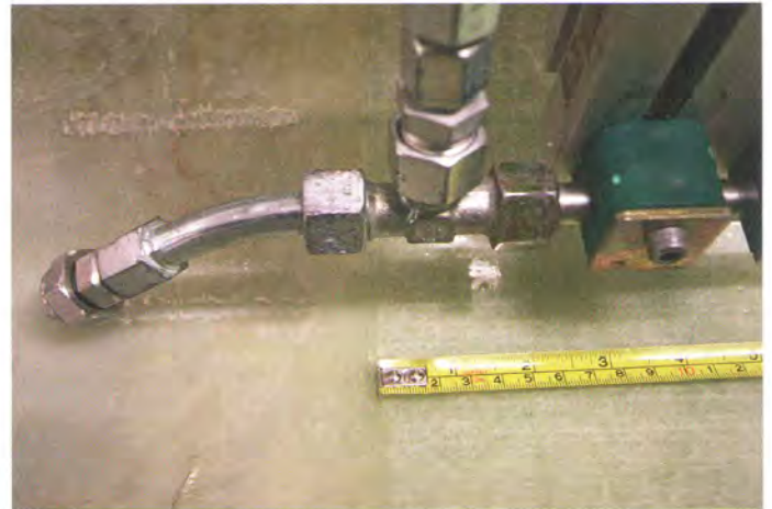
Bild 2. PARTLINER™ im Spülversuch
