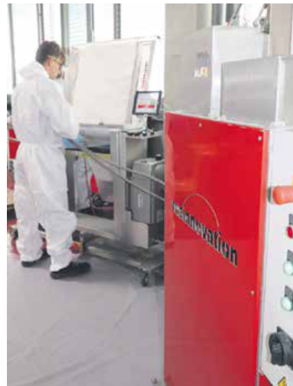
Von der Dosiertechnik wird das gemischte Harz durch den Anwender direkt zum Vakuum-Imprägnierer übertragen.
