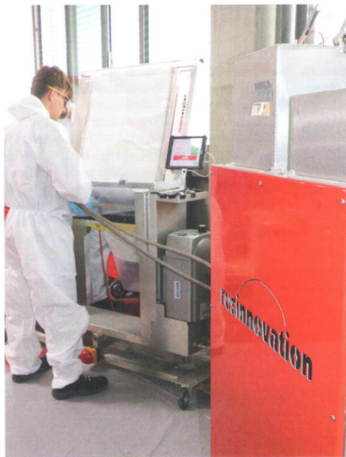
Von der Dosiertechnik wird das gemischte Harz durch den Anwender direkt zum Vakuum-Imprägnierer übertragen. | Fotos: resinnovation
