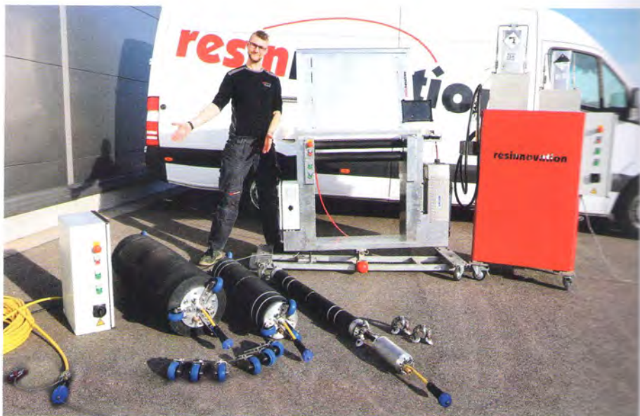
Live am resinnovation-Außenstand in Aktion zu sehen: das komplette Partliner-System mit Vakuum-Imprägnierer und Dosier-technik (rechts), Partliner E-Packern und dem neuen E-Packer Control (links) | Foto: resinnovation
