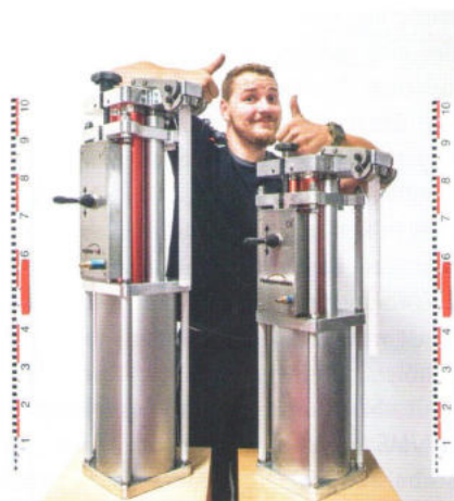
Vergleich der 4K-Pastenmischanlagen Version 1.3 und 1.1. Aus einer Befüllung der größeren, auf Roboter mit Schalungssystem ausgerichteten 4K 1.3 erhält man 3 Liter gemischtes Harz14 bzw. Harz12. | Foto: resinnovation
