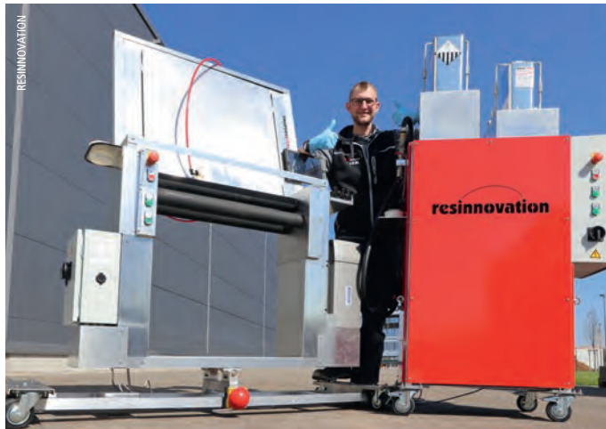
Das Partliner-System macht zur IFAT den Schritt in Richtung »Industrie 4.0« – Harzmengenbestimmung, Mischen, Imprägnieren und Dokumentation laufen bei dem System in einem App-gesteuerten, teilautomatisierten und selbstkontrollierenden Verfahren ab. Dadurch sind Ausführung und Ergebnis – ein luftfrei imprägnierter, korrekt kalibrierter Kurzliner – fehlerfrei reproduzierbar. Für ein qualitativ einwandfreies Ergebnis wird nichts dem Zufall überlassen.
