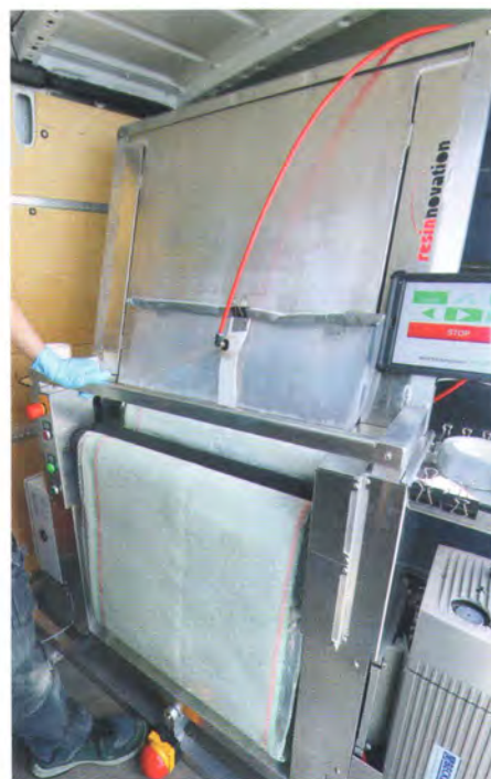
Der Partliner wird im Vakuum-Imprägnierer luftfrei getränkt und kalibriert. | Fotos resinovation
