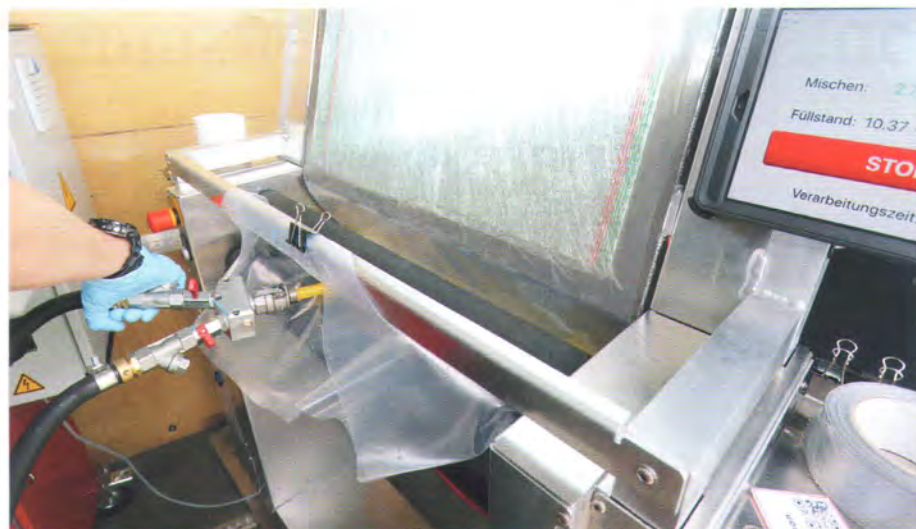
Das Harz wird via Statikmischer direkt von der Dosiertechnik in den Folienschlauch mit der unter Vakuum gesetzten GF-Matte eingebracht.
