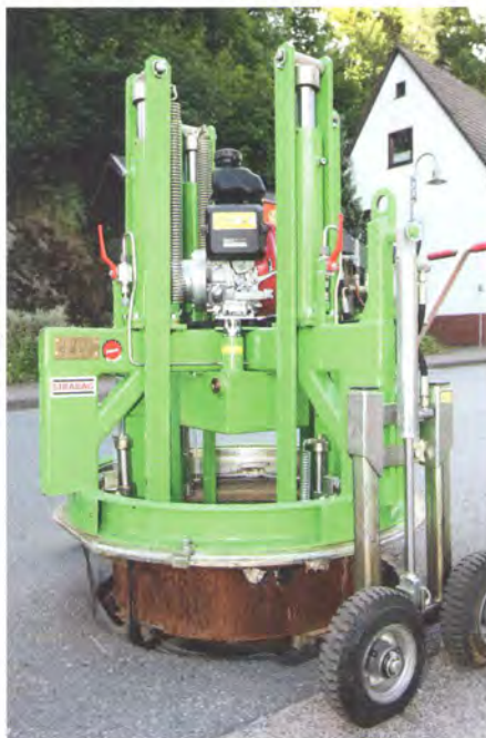
Abb. 1: Mit dem Schachtrahmenhebergerät wird der Rahmen der Abdeckung herausgehoben
