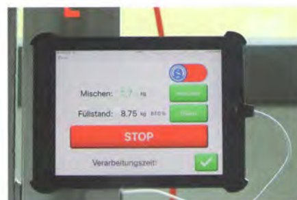
Bild 2. Software-gesteuertes automatisiertes Mischen
