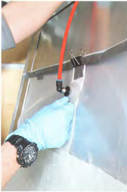
Bild 3. Imprägnieren unter Vakuum
