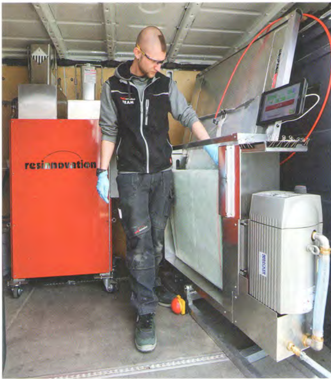
Bild 4. PARTLINER-System beim Vakuum-Imprägnieren
