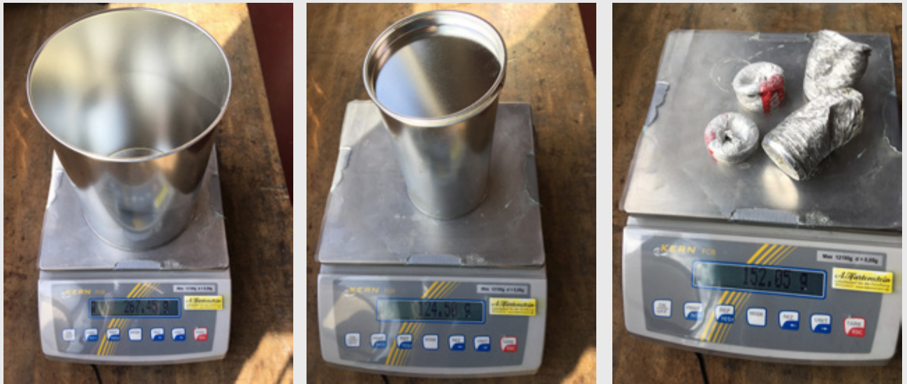
Bild 7: Gewichtsvergleich der Abfallmenge von Dosen – hier noch leer und ohne Produktreste – mit der Abfallmenge restentleerter Schlauchbeutel
