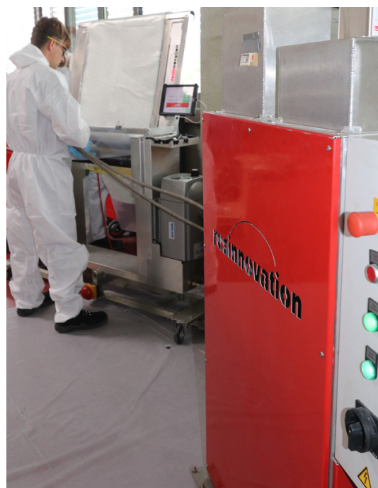
Partliner-System: Von der Dosiertechnik wird das Harz durch den Anwender direkt zum Vakuumimprägnierer übertragen.
